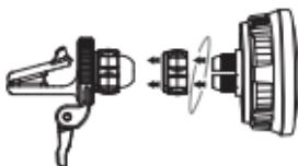
2 將出風口夾子套入固定孔。
