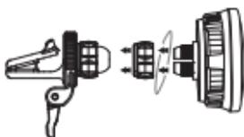
2 将出风口夹子套入固定孔。
