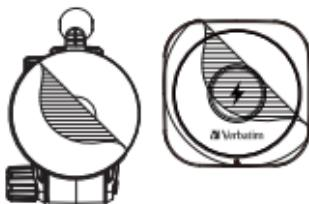
1 移除吸盘底部和磁吸无线充电器表面上的保护膜，并把吸盘贴紧于干净平面。
