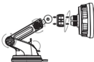
2 将仪表板支架套入充电器背部的固定孔，顺时针锁紧旋转球固定螺母，调整支架臂及伸缩杆至最方便合适角度。
