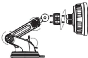
2 將儀表板支架套入充電器背部的固定孔，順時針鎖緊旋轉球固定螺母，調整支架臂及伸縮杆至最方便合適角度。
