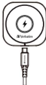
3 把Type C充电线连接至电源输入端口。
